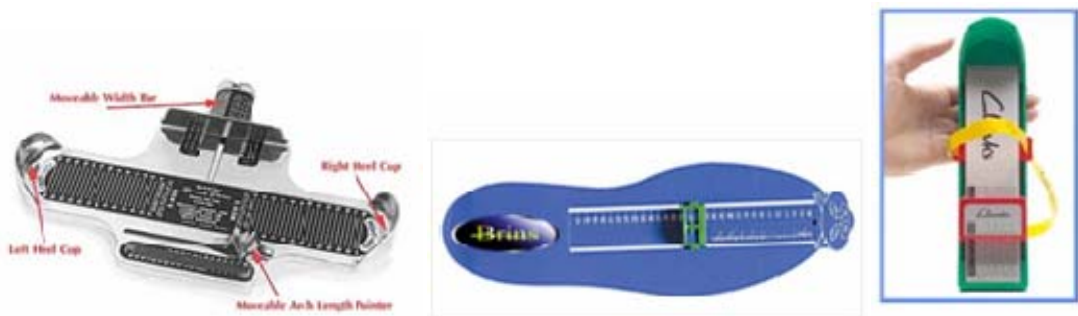
Фигура 10. Уреди за измерване на ходилото от Бранок, Бринк и Кларкс (от ляво надясно)
